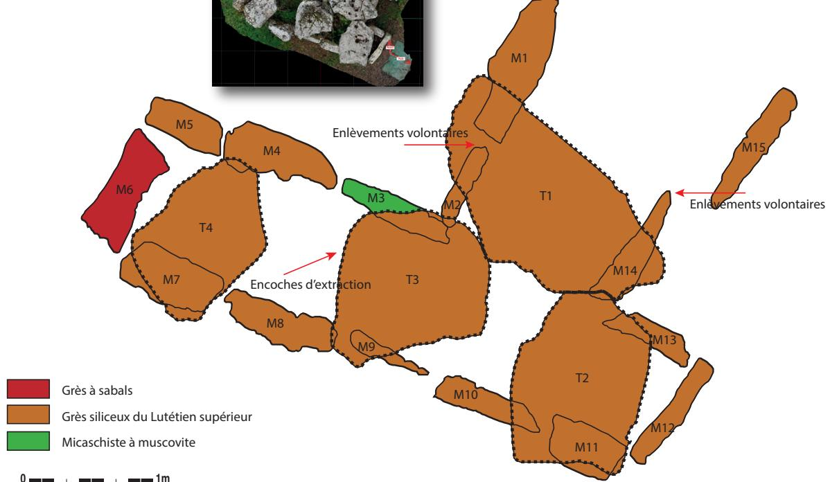
Fig. 14 : Géologie des blocs qui ont été utilisés pour la réalisation du dolmen de Monval. La plupart de ces derniers proviennent de grès siliceux dont les sources sont proches du site. Un bloc est réalisé en micaschiste local et la pierre de chevet ouest est un grès à sabals de couleur rougeâtre.
